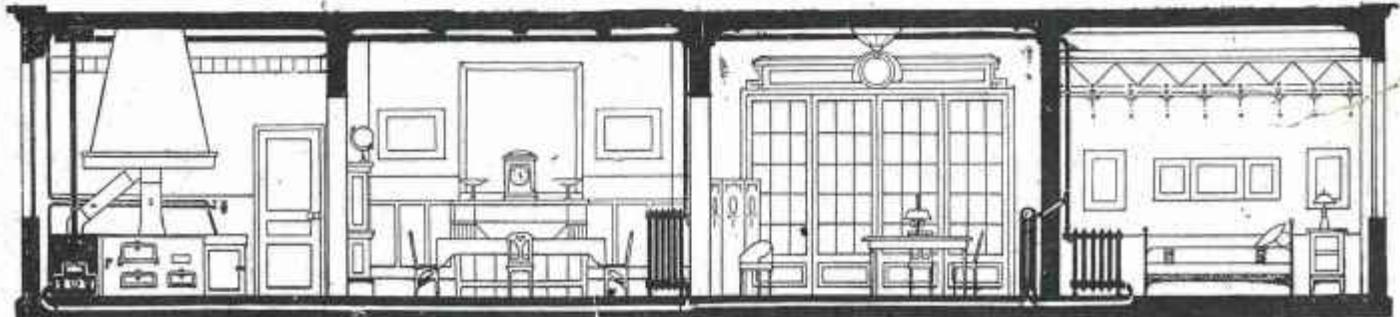
Schéma d'une installation de chauffage à niveau d'un appartement, par chaudière Type "Culina", posée en annexe à un fourneau de cuisine.
